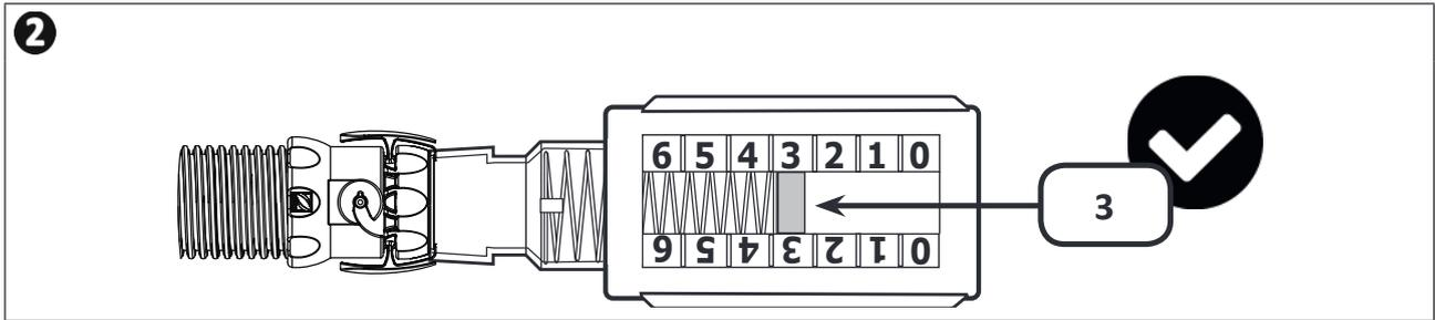
Si nécessaire, utiliser les vannes de la piscine pour ajuster le débit de façon à ce que le témoin soit sur la position 3.
