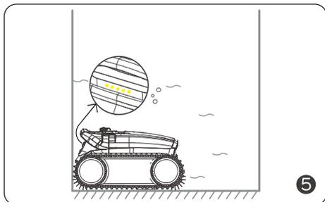
L'appareil se déplacera automatiquement pour s'arrêter près du bord du mur une fois le nettoyage terminé ou lorsque la batterie est faible.
