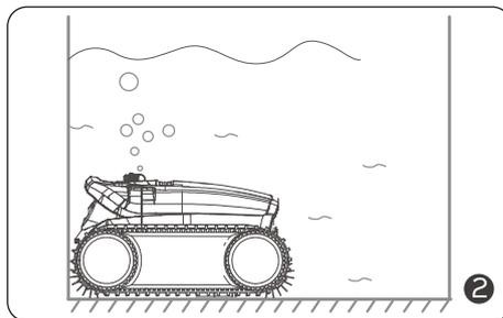
Laissez-le couler jusqu'au sol pour vider l'air emprisonné à l'intérieur.
