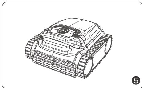
Après le rinçage, remettez le panier-filtre et la mousse de coton dans le nettoyeur et refermez le couvercle.
